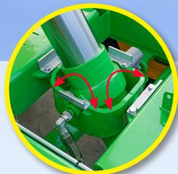
Vérin télescopique de bannage à double oscillation placé dans une position avancée dans le châssis
