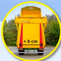
Fluidité de vidange grâce à une caisse conique en HARDOX 450
