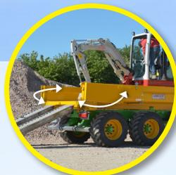
2 possibilités d'ouverture de porte pour répondre à tous vos besoins : ouverture manuelle des 2 vantaux latéraux ou ouverture hydraulique de la porte à grand dégagement
